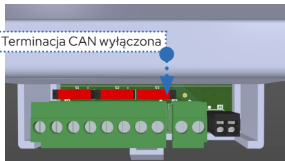
Rys. 16: Terminacja połączenia CAN wyłączona (przełącznik w lewym położeniu)
