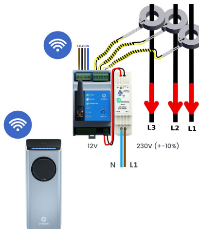
Rys. 5: Schemat podłączenia 3-fazowego wariantu ENELION ENERGY GUARDA
