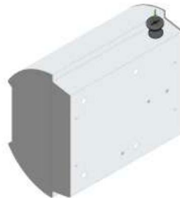
Rys. 17: Miejsce montażu dodatkowej zaślepki.
