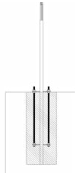
Rys. 30: Przekrój zabetonowanego zestawu fundamentowego.
