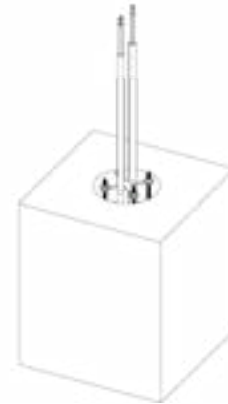
Rys. 29: Poprawnie umieszczony zestaw fundamentowy w wykopie.
