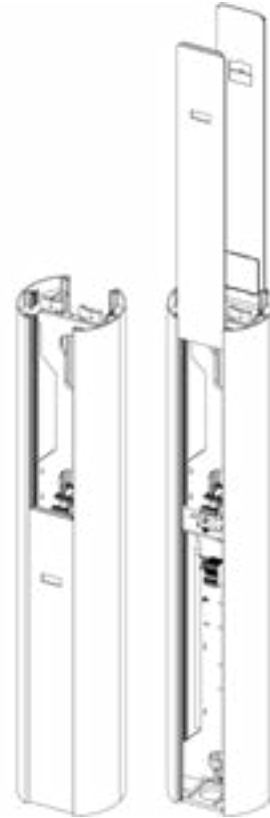
Rys. 34: Wysuwanie dolnych paneli maskujących ze Słupa ENELION VERTICA.
