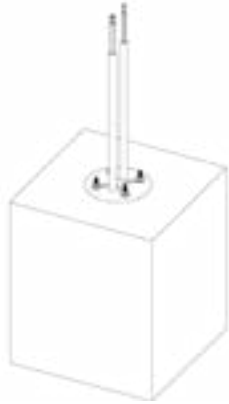
Rys. 31: Poprawnie zabetonowany zestaw fundamentowy.
