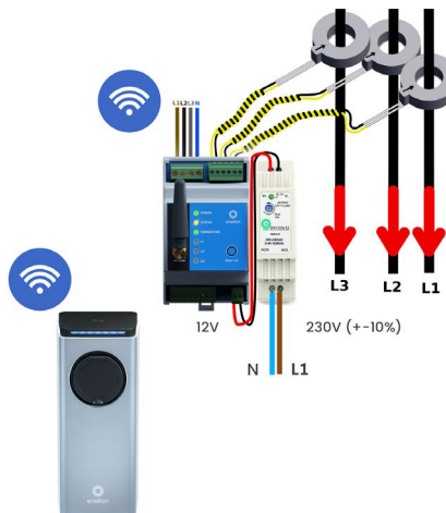
Rys. 5: Schemat podłączenia 3-fazowego wariantu ENELION ENERGY GUARDA
