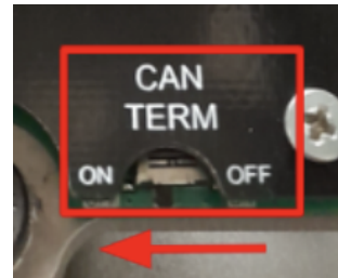
Rys. 59: Przełącznik terminacji magistrali CAN na module ENELION VERTICA link. W celu włączenia terminacji przestawić przełącznik w pozycję „ON”
