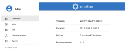
Rys. 8: Widok sekcji Dashboard w panelu konfiguracyjnym EEG 3.0
